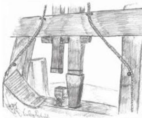
De slaghei (rechts) en de loshei (links) boven de wiggen in het voorslagblok
